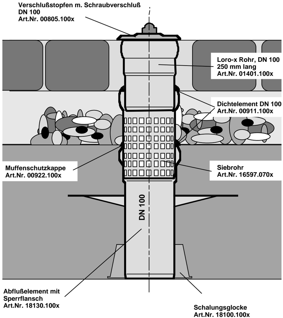
Anbindung an die Grundleitung KG mittels Übergangsdichtung
